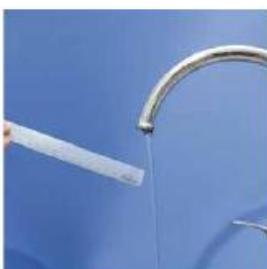
Al frotar la regla con lana, se produce el fenómeno de electricidad estática. El plástico, material eléctricamente neutro y no conductor, al ser frotado queda cargado. La desviación del hilo de agua al acercar la regla cargada confirma la polaridad de la molécula de agua. Dependiendo de cuál es la carga del material que se le aproxima, las moléculas de agua se orientarán con la carga opuesta; en todos los casos se observa la desviación del hilo.
