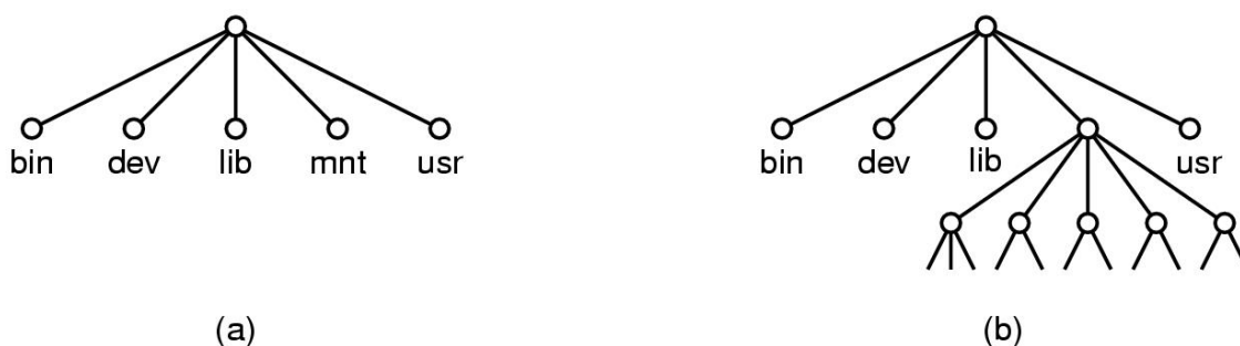
Figura 1-22. (a) Sistemas de ficheros antes del montaje. (b) Sistema de ficheros después del montaje.
