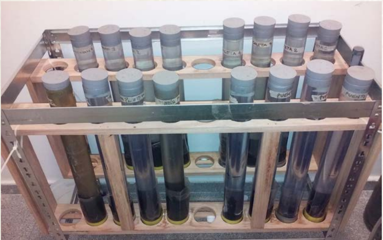
Fig. 23- Experimentos de liberación de nutrientes desde los sedimentos. Corers de sedimento de 4 lagos de la Ciudad de la Costa y Paso Carrasco utilizados para realizar experimentos de liberación de nutrientes hacia la columna de agua (experimento en desarrollo en junio 2017).
