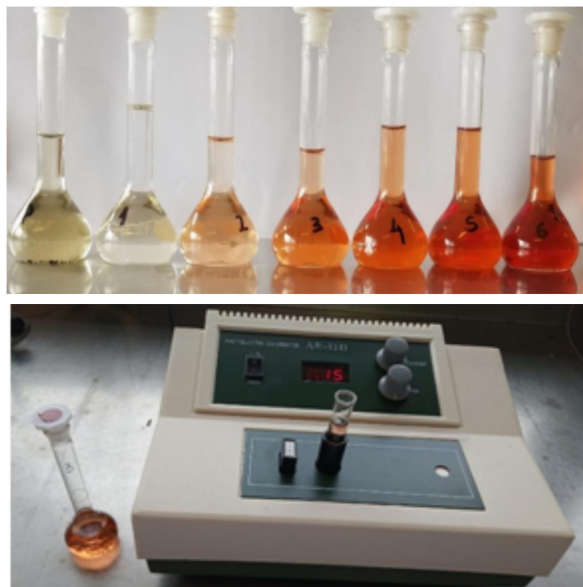
Desarrollo de color y medición de absorbancia usando un fotocolorímetro.
