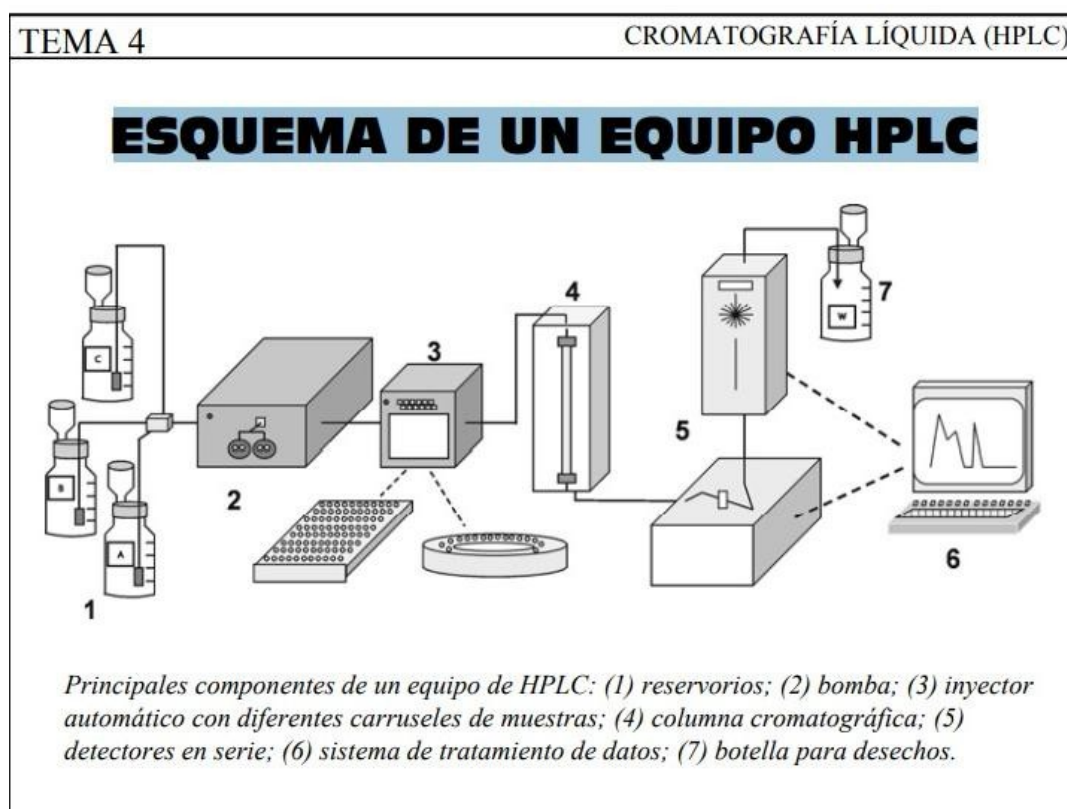
Ilustración 5-Esquema de un equipo HPLC, HPLC-2011 (2018)
