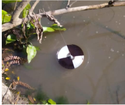
Imagen N°8: Determinación de la turbidez. Disco de Secchi.
