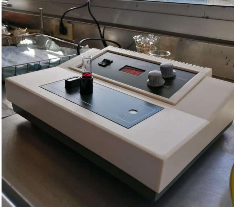
Figura 16. Fotocolorímetro empleado en la práctica.
