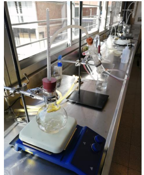
Figura 11. Fotografía del proceso de destilación de la muestra.
