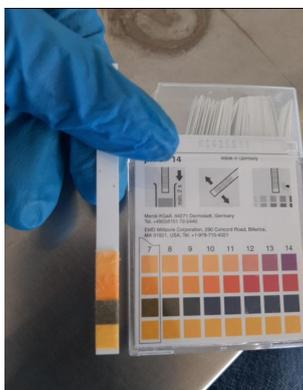
*Imagen N°6: Determinación del pH de la muestra con tirillas.*
