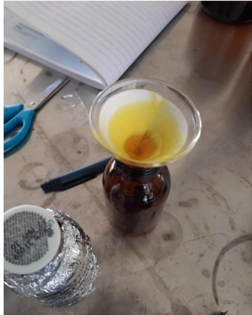
*Imagen N°17: Filtrado del precipitado*
