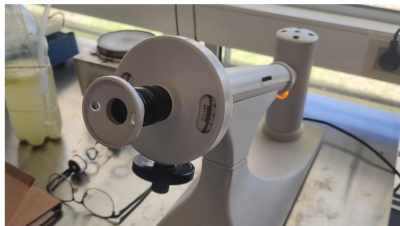
Figuras 24 y 25. Realización del reconocimiento de glucosa por polarimetría. / Polarímetro.
