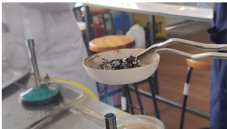
Figura 16. Calcinación de una de las muestras de papel previo a la mufla
