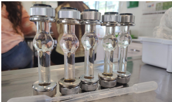
Figuras 24 y 25. Realización del reconocimiento de glucosa por polarimetría. / Polarímetro.
