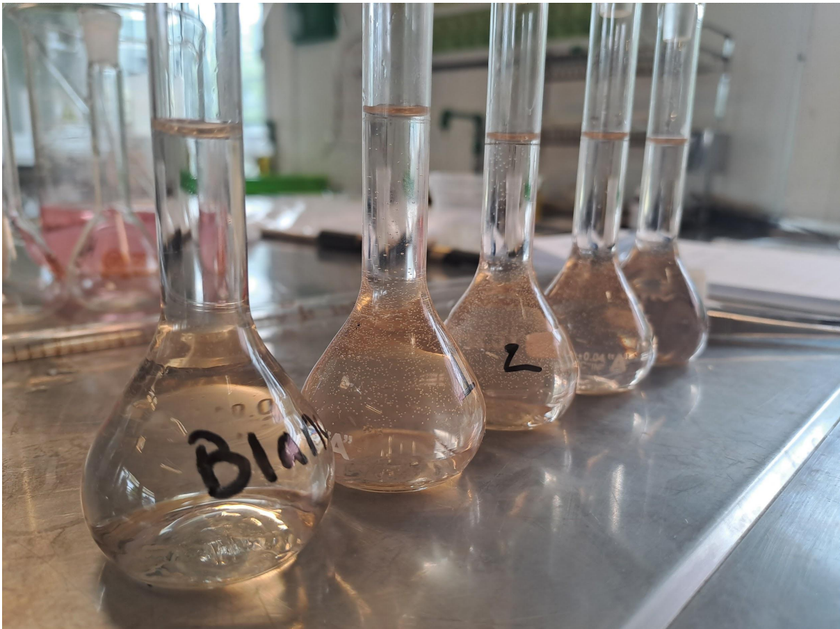
Figura 27. Desarrollo de color de la curva de calibración
