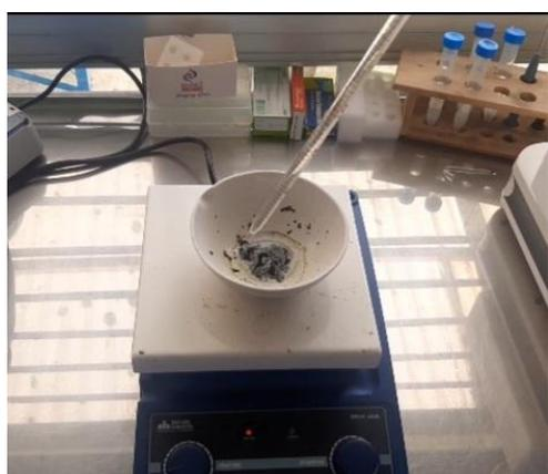
*Imagen N°22: Agregado de HCl 1:1 a la muestra.*
