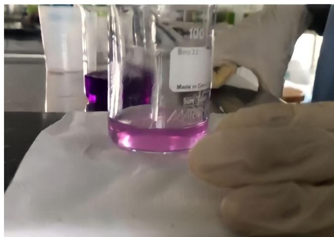
Imagen N°24: Inicio de la valoración de la muestra con EDTA. Imagen N°25: Final de la valoración.
