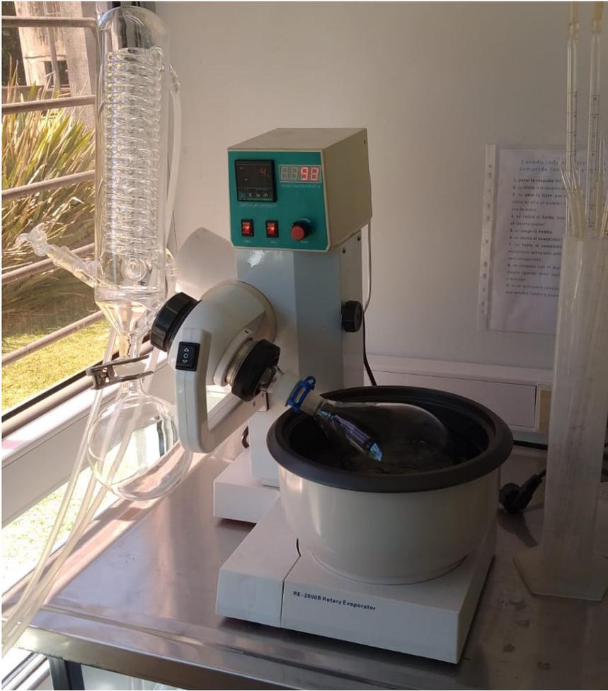
*Imagen n°14, separación del solvente por rotaevaporación.*
