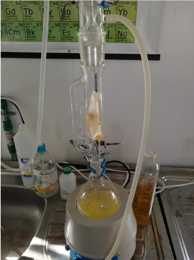
Imagen n°13, extracción del aceite mediante Soxhlet.
