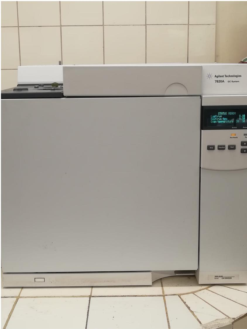
*Imagen n°16, horno del cromatógrafo de gases.*
