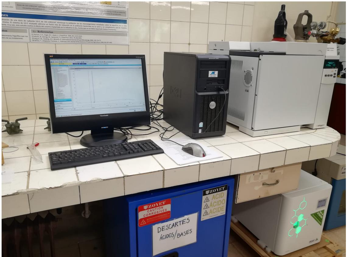
*Imagen n°15, equipo utilizado para la cromatografía de gases.*
