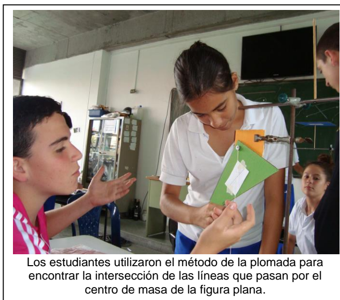
Imagen 24. Determinación del centro de masa de figuras planas.
