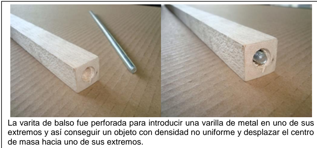
Imagen 1. Construcción de las varita #2
