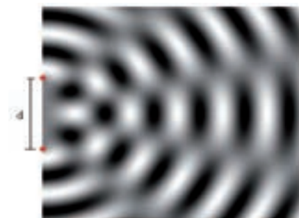
Fig. 6c. Interferencia de ondas en la cubeta. Se observan claramente las líneas nodales (interferencia destructiva)
